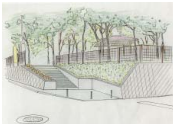
改修により階段が増設される
